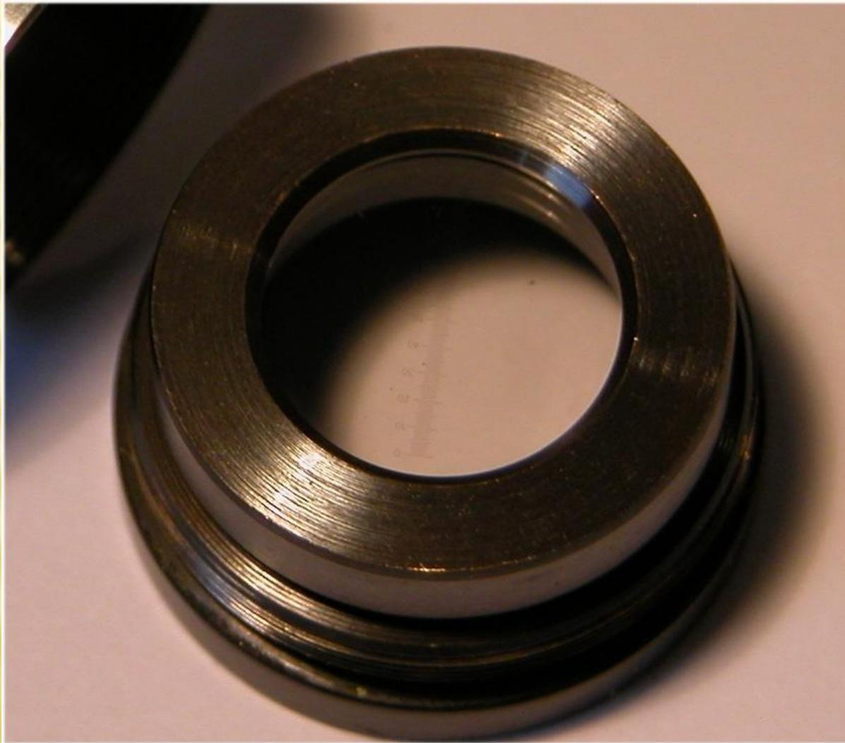
Cette échelle se trouve positionnée dans le plan de l'image intermédiaire de l'objet microscopique formée par l'objectif et acheminée vers l'oculaire par le tube.
