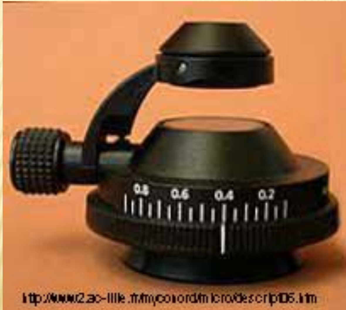
Figure 26 : Condenseur à lentille escamotable O.N. 0,16 - 0,9
